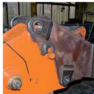
Der Umbau angelieferter Monoblock-Baggerarme wird in der Sonderbauabteilung der Firma Henle in Rammingen realisiert. Im hauseigenen Fräszentrum wird ein neues, per CAD entwickeltes Schnellwechselmodul an den zuvor verstärkten Monoblock angeschweißt.
