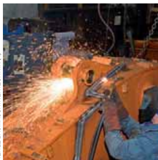
Der Umbau angelieferter Monoblock-Baggerarme wird in der Sonderbauabteilung der Firma Henle in Rammingen realisiert. Im hauseigenen Fräszentrum wird ein neues, per CAD entwickeltes Schnellwechselmodul an den zuvor verstärkten Monoblock angeschweißt.
